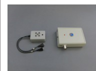
送信側: 出力:TTL 押しボタンスイッチ パイロットランプ付 単3電池×2個駆動 受信側: データログと接続 LED表示あり
