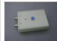
出力:2系統 (Short, TTL) 押しボタンスイッチ パイロットランプ付 単3電池×2個駆動
